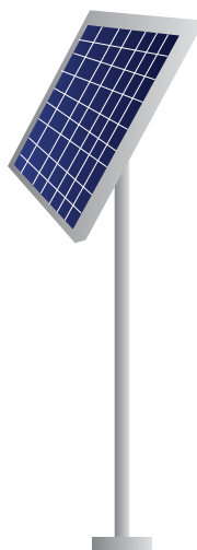
Colocación tipo poste
